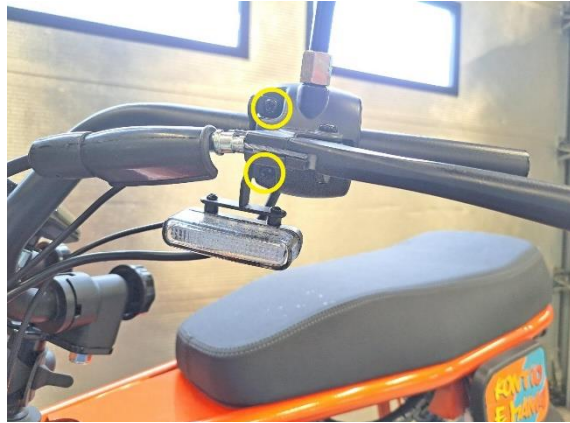
Löysää vasemman kahvarungon kiinnityspultit (ristipäämeisseli ph2).
